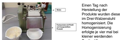
Abbildung 3: Drei-Walzenstuhl zum Homogenisieren der Produkte, hier der O/W-Emulsion
