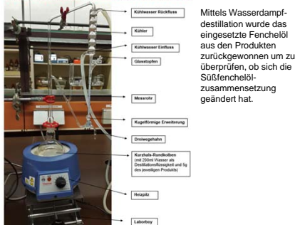
Abbildung 2: Aufbau der Wasserdampfdestillation für die Produkte
