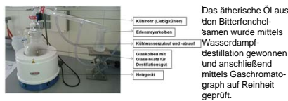
Abbildung 1: Aufbau der Wasserdampfdestillation der Fenchelsamen
